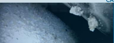
Vista interna di un dispositivo SCR Truck con massiccia incrostazione di Adblue cristallizzato.
